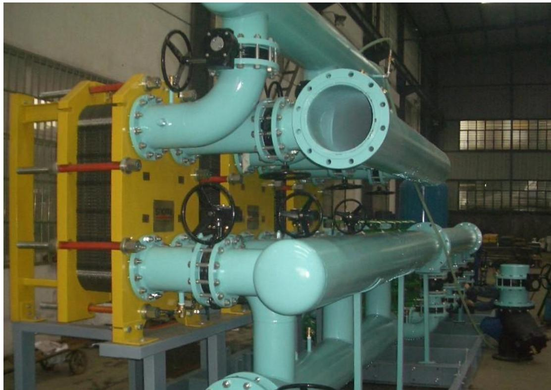
沙特位于水资源紧张的中东，和传统开式冷却系统设计不同，SPCC 及 RCC、YCC、SCC、AYCC 等项目均采用闭式循环水冷却系统，按沙特电压与电流专业设计的整体板式换热撬装与冷机组合负责系统循环水冷却。该撬装装置在工厂生产和测试后，通过海运交付至现场，由艾克森提供现场调试和培训服务。上述项目中艾克森的撬装设备运行状态良好，为中东最大经济体沙特阿拉伯推进“愿景 2030”战略，满足大规模基础设施及巨型项目的水泥需求提供了强劲引擎。
