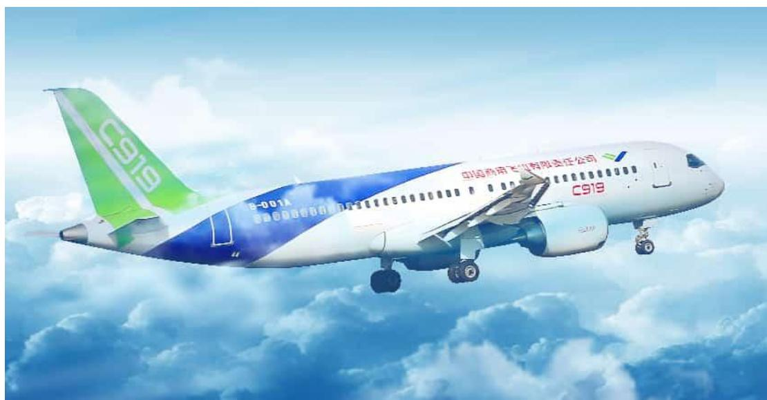
在使用材料上, C919 采用大量的先进复合材料、先进的铝锂合金等, 再通过飞机内部结构的细节设计, 进一步降低飞机整体重量。由于大量采用复合材料, 较国外同类型飞机 80 分贝的
